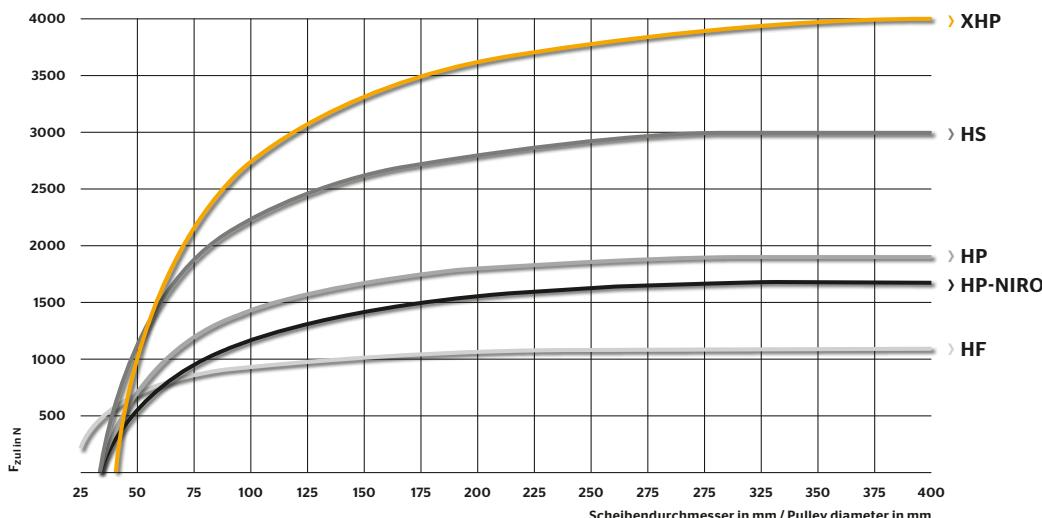
$F_{zul}$  in Abhängigkeit des Scheibendurchmessers (normiert auf 10 mm Riemenbreite)
