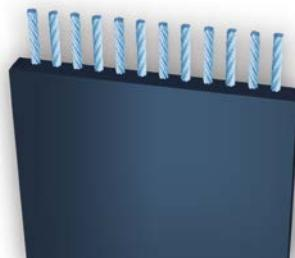
Das Außenmaterial des CONTI® POLYFLAT PU-Flachriemens besteht aus Polyurethan; der Zugträger aus einer Litzenkonstruktion. Die beiden gegenläufigen Schlagrichtungen der Stahlcorde und ihrer Litzen bewirken ein neutrales Laufverhalten.
