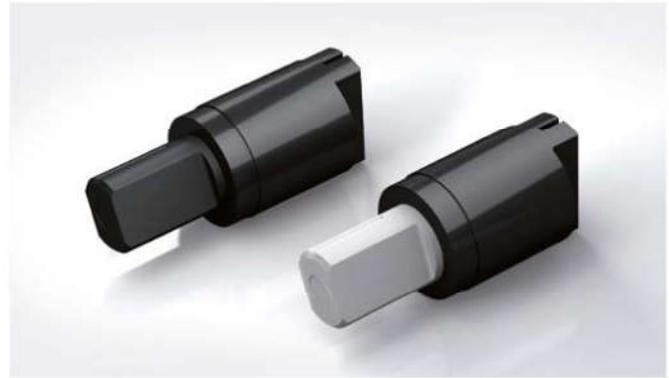
Die Bremsrichtung der Rotationsbremse FYN-P1 kann entweder rechts oder links drehend sein. Die Bremsen können direkt im Drehpunkt montiert werden. Bei der jeweiligen Umkehrbewegung der einseitig bremsenden Ausführungen entsteht je nach Baugröße ein gewisses Rückdreh-Bremsmoment. Unterscheidung der Dämpfungsrichtung durch farbigen Schaft. ACE Rotationsbremsen sind wartungsfrei und einbaufertig.
