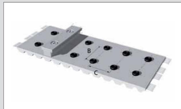
Die Ausformungen für die Einlegeteile sind fertigungsseitig mit einer ca. 0,2 mm dicken TPU-Haut verschlossen. Zum Einsetzen der Profilbefestigung müssen diese Ausformungen geöffnet werden. Möchten Sie den Zahnriemen gelocht geliefert bekommen, dann teilen Sie bitte Ihrem zuständigen BRECO-Vertriebspartner bei der Bestellung den gewünschten Abstand C mit. Der kleinste Längsabstand der Ausformungen im Riemenzahn entspricht der Teilung des Riemens.
