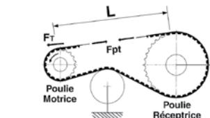
Transmission à axes multiples / Multiple Pulley Drive / Mehrwellenantrieb
