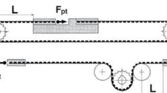
Transmission simple à deux axes / Two Pulley Drive / Einfacher Zwei-Achsen-Antrieb
