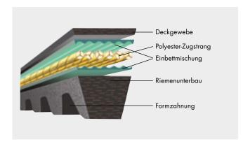
Der Riemenunterbau besteht aus einer Polychloropren-Gummimischung mit quer zur Laufrichtung ausgerichteten Fasern, die den Zugstrang wirksam abstützen.
