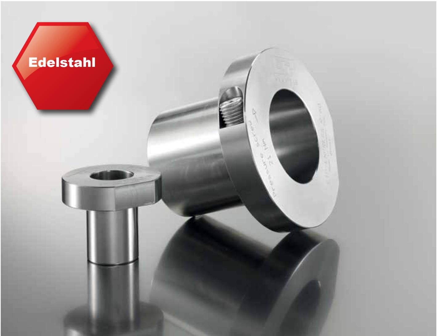
ETP-EXPRESS R gibt es standardmäßig für Wellendurchmesser von 15-80 mm (auch in Zoll). Rundlauf  $\leq 0,02$  mm. Anzahl der Montagen: 200 – 800 (abhängig von der Dimension). Die äußerst kleinen Einbaumaße ergeben eine kompakte Konstruktion mit geringem Gewicht und Trägheitsmoment.
