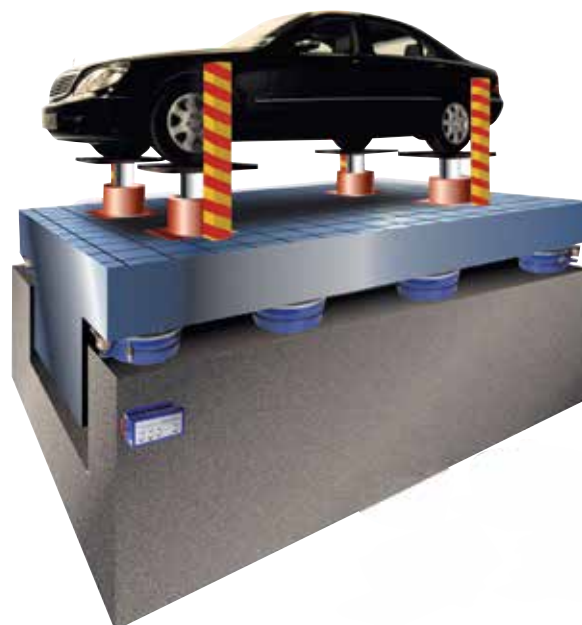
Prüfstände, Beispiel Straßensimulationsprüfstand
