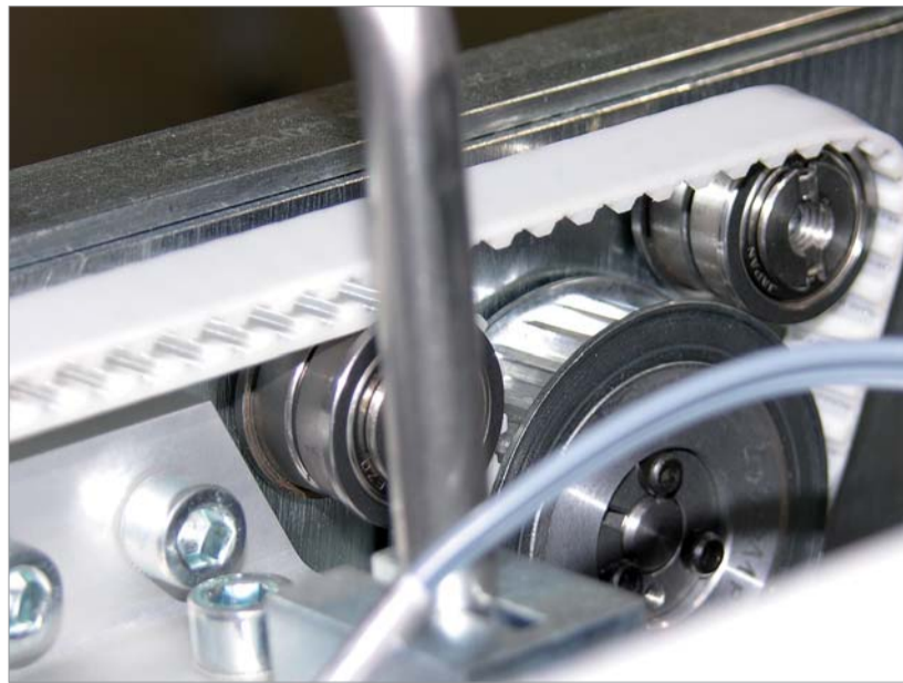
Präzise und schnell: das Leiterplatten-Transportsystem mit einem Polyurethan-Zahnriemen Breco 10 T5 / 2930 - V in Omegaanordnung.
