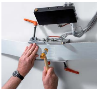
Die Entwickler bei Hilger u. Kern haben an alles gedacht: der Hammer zum Ausrichten des Zahnriemens in der Schweißform ist im Standardlieferungsumfang enthalten.
