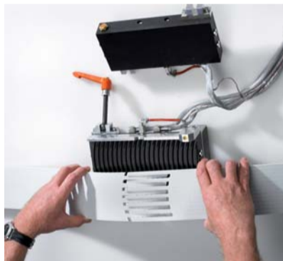
Einlegen des gestanzten Polyurethan-Zahnriemens in die untere, profilierte Schweißform, hier passend für einen BRECO-Zahnriemen mit bogenförmigem BAT-Profil.
