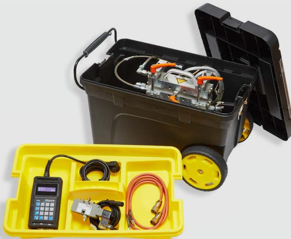
Auch die beste Qualität unterliegt einem betriebsbedingten Verschleiß. Von Fall zu Fall müssen daher auch Polyurethan-Zahnriemen ausgewechselt werden. Für Antriebseinheiten, die nur mit größerem Montageaufwand zu wechseln und durch vorgeschaltete Maschinenteile schwer zugänglich sind, ist das tragbare Schweißgerät TSG 5 die ideale Lösung. Es ist einfach zu bedienen und
