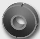
Der vierteilige Außenring des Ringelementes wird in eine Bohrung mit Untermaß eingepresst. Auf diese Weise kann eine Welle, die in der inneren Buchse montiert wird, elastisch gelagert werden.
