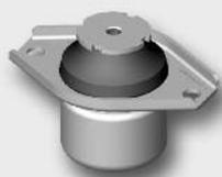
Diese Baugruppe ist für kleine bis mittlere Lasten geeignet und ist besonders da interessant, wo neben Vibrationen störende Stöße auftreten und die Eigenschwingungen des Systems rasch abklingen sollen (Beispiel: Kabinenlagerungen von Flurförderzeugen). Dies wird durch die hydraulische Dämpfung erreicht.
