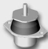
Dieses Hydrolager zeichnet sich durch eine integrierte, sehr breitbandige Dämpfung in Hochrichtung aus und dämpft damit Stöße besonders gut ab. Darüber hinaus verfügt es über einen integrierten Zuganschlag. Einsatzschwerpunkte sind die Kabinenlagerung bei Gabelstaplern sowie die Motorlagerung von verschiedensten Industriefahrzeugen, von leichten Gabelstaplern bis hin zu schweren Baumaschinen.
