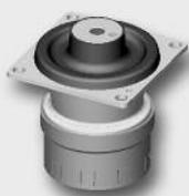
Das robuste und abreißsichere Hydrolager Serie K ist mit seiner hohen Quersteifigkeit und der hydraulischen Dämpfung in Hochrichtung besonders für die Lagerung schwerer Kabinen im Baumaschinenbereich geeignet, bietet sich aber auch zur Lagerung großer Motoren an. Mit gleichen Anschlussmaßen auch ohne hydraulische Dämpfung erhältlich.
