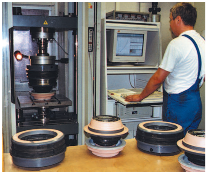
Steifigkeitsmessung an einem MEGI-Bauteil
