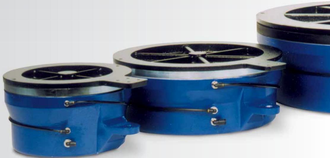
Die Standard-PAL-Isolatoren haben eine Eigenfrequenz bis zu 1,7 Hz – abhängig von der Isolatorhöhe. Bei kundenspezifisch hergestellten Isolatoren sind sogar noch niedrigere Eigenfrequenzen (bis 0,5 Hz) möglich.
