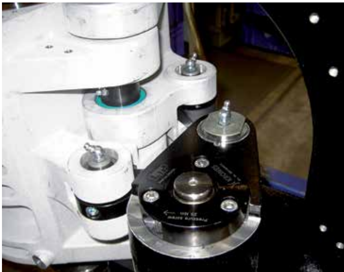
Hebel wird mit ETP-EXPRESS gespannt, um die Form zu öffnen/schließen.
