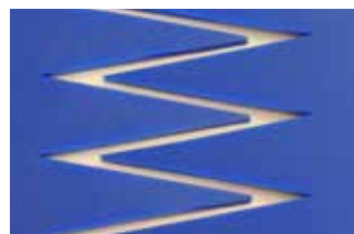
Fingerverbindung mittels Heißpresse
